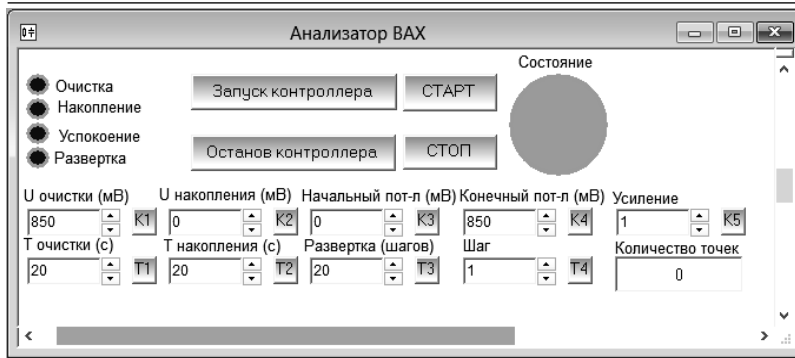
Рис. 4. Лицевая панель прибора «Анализатор ВАХ»
