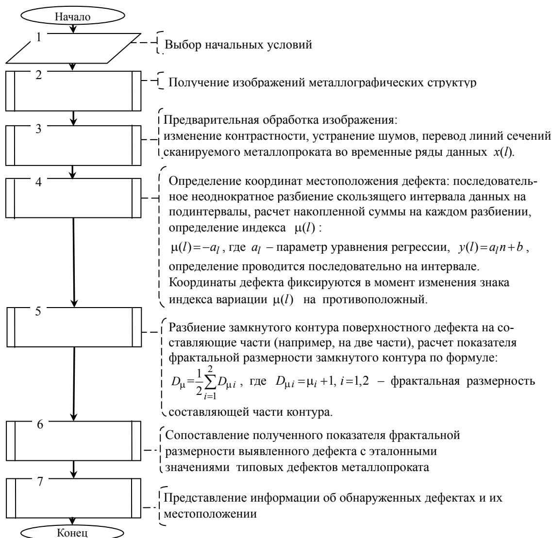
Рис. 2. Блок-схема способа оценивания качества поверхности металлопроката
