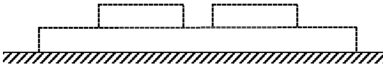
Рис. 1. Исследуемая конфигурация из двух проводников и диэлектрика
