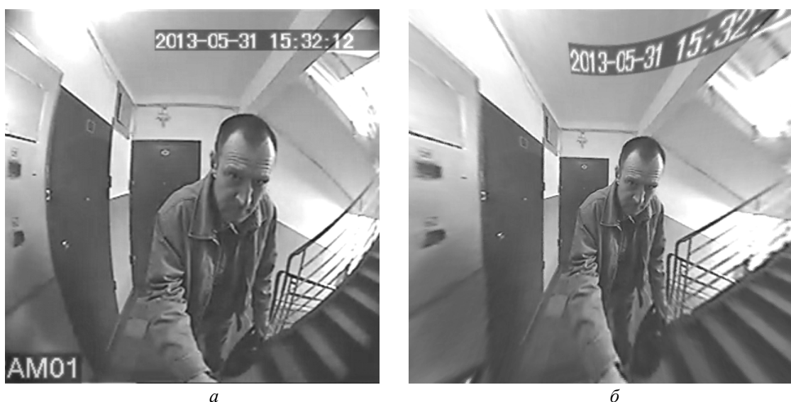
Рис. 5. Входное и реконструированное изображение: a – входное искаженное изображение; б – восстановленное изображение после применения алгоритма адаптивной линейной интерполяции
