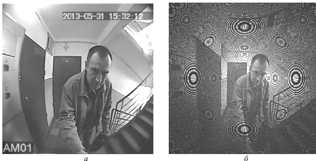
Рис. 3. Применение алгоритма коррекции координатных искажений для изображения с «видеоглазка»
