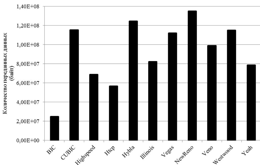
Рис. 1. Сравнение вариантов механизмов управления нагрузкой
