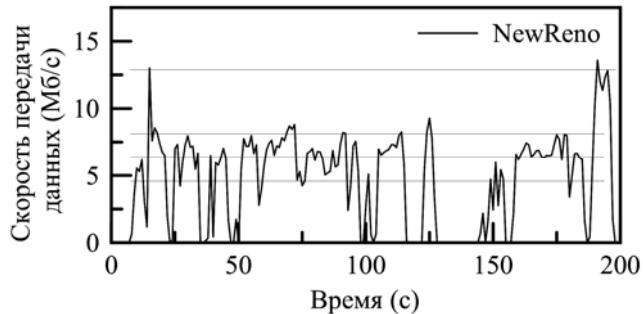
**Влияние длины маршрута на пропускную способность TCP соединения.** В ходе проведения эксперимента была использована симуляционная модель с неподвижными узлами, выстроенными в линию (топология «цепь»). Клиент и сервер установлены на окончательных узлах данной цепочки. Посторонний трафик в сети отсутствовал.
