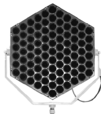
Рис. 1. Внешний вид 91-элементной антенной решетки с лицевой стороны
