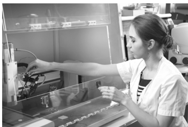
Рис. 2. Рабочее место плоттерной печати (а) и нанесение чернил в виде линий на поверхность подложки капиллярным дозатором плоттера (б)
