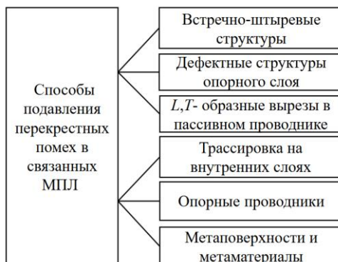
Рис. 3. Структурная схема конструктивных способов подавления перекрестных помех в связанных МПЛ
