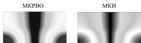
Рис. 9. Результаты расчета моды прямоугольного волновода с частичным диэлектрическим заполнением с помощью МКИ и МКРВО
