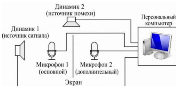
Рис. 5. Эскиз экспериментальной установки
