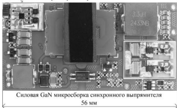
Рис. 3. Внешний вид макета высокоплотного DC-DC-преобразователя на основе силовых GaN-микросборок
