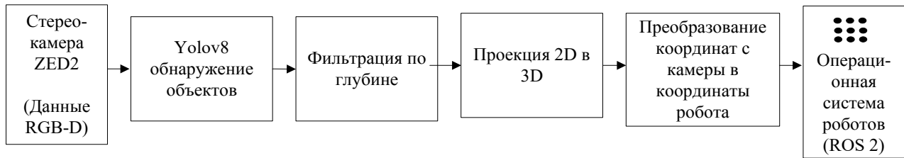
Рис. 1. Функциональная блок-схема предлагаемой роботизированной системы с визуальным управлением
