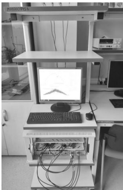
Рис. 4. Общий вид SDR-демонстратора технологии ДО
