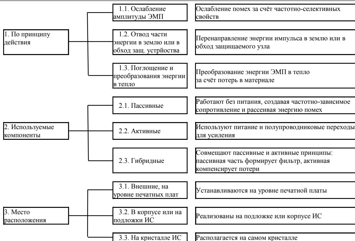
Рис. 3. Классификация средств защиты ИС от ЭМП
