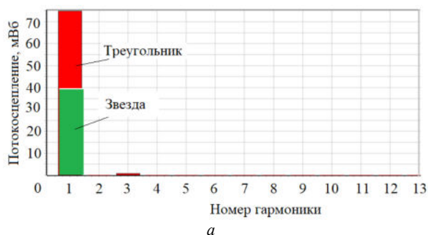
Рис. 5. Гармонический состав потокосцепления (а) и противоЭДС (б) вариантов обмоток ТЭД
