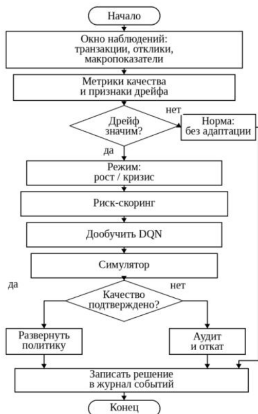
Рис. 2. Блок-схема алгоритма мониторинга дрейфа и адаптации рекомендательной политики
