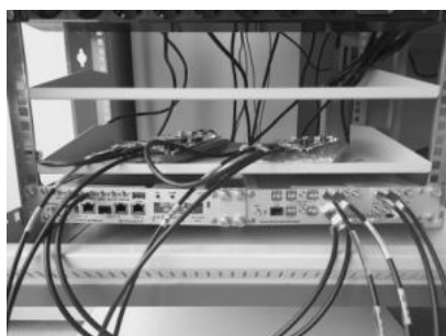
Рис. 3. Подсистема частотно-временной синхронизации на базе устройств Метроном
