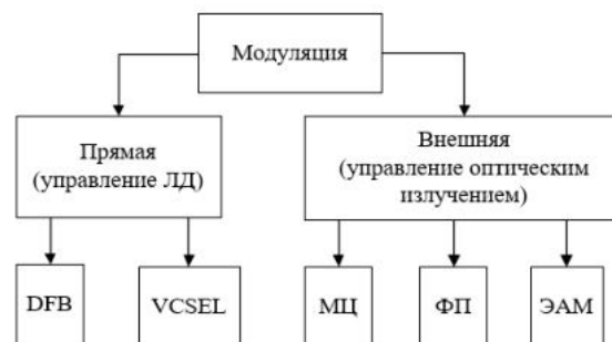
Рис. 1. Виды оптической модуляции
