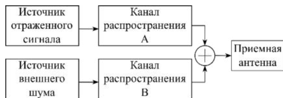
Рис. 1. Структурная схема преобразований входного сигнала
