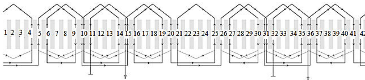
Рис. 3. Схема фазы обмотки ТЭД
