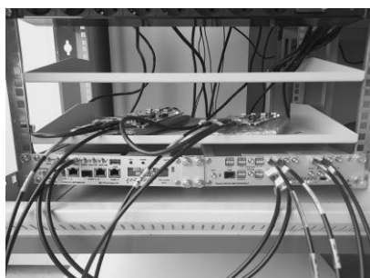
Рис. 3. Подсистема частотно-временной синхронизации на базе устройств Метроном
