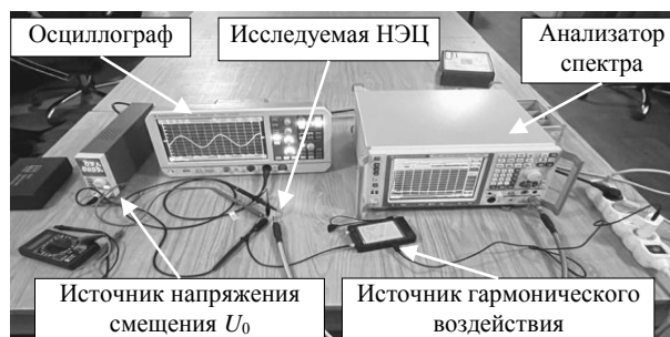
Рис. 3. Лабораторная установка для измерения выходного тока исследуемой НЭЦ
