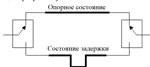
Рис. 1. Эквивалентная схема фазовращателя на основе линий задержки
