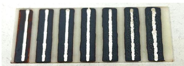
Рис. 7. Напечатанные МПЛ с подслоем феррита толщиной от 20 до 500 мкм соответственно
