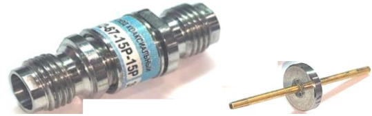
Рис. 8. Измерительный макет на основе одноканального коаксиального перехода с сечением 1,85/0,804 мм
