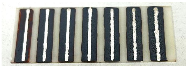
Рис. 7. Напечатанные МПЛ с подслоем феррита толщиной от 20 до 500 мкм соответственно
