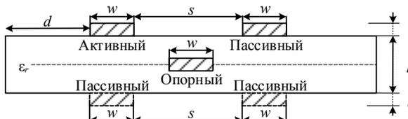
Рис. 13. Поперечное сечение ПП с опорным проводником в центре [25]
