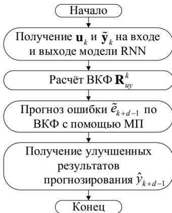
Рис. 3. Алгоритм повышения качества нейросетевого моделирования динамических объектов
