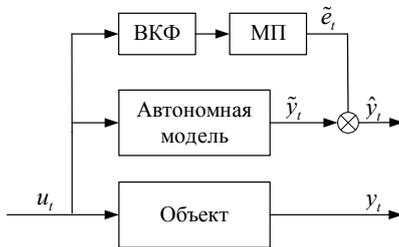
Рис. 2. Предложенная улучшенная автономная модель и моделируемый объект
