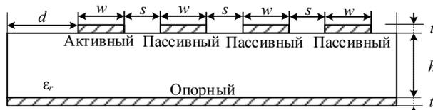
Рис. 17. Поперечное сечение четырехпроводной ПП [35]
