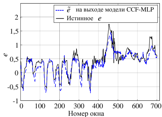
Рис. 13. Сигнал \tilde{e} на выходе модели CCF-MLP
