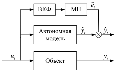
Рис. 2. Предложенная улучшенная автономная модель и моделируемый объект
