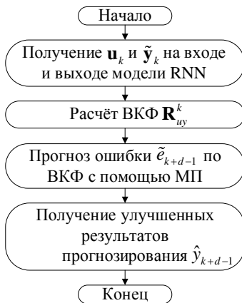
Рис. 3. Алгоритм повышения качества нейросетевого моделирования динамических объектов
