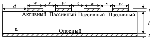
Рис. 17. Поперечное сечение четырехпроводной ПП [35]
