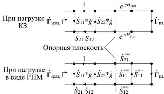
Рис. 7. Потоковый граф измерительной системы: g – комплексная импульсная характеристика фильтра; (*) – символ свертки
