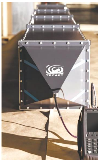
Рис. 1. Фотография прототипа КИЛ для измерения одиночных образцов РПМ
