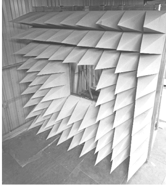
Рис. 3. Фотография нагрузки в виде РПМ, размещенного в полноразмерную КИЛ
