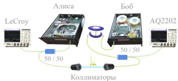
Рис. 1. Схема 1: система квантового распределения ключей Clavis 2 ; осциллограф LeCroy 104Xs; модульная система Yokogawa AQ2202; коллиматоры с эффективным фокусным расстоянием 100 см, ВОЛС
