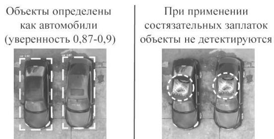
Рис. 4. Сценарий использования состязательных заплаток для обмана систем детектирования объектов (сокрытие объекта)
