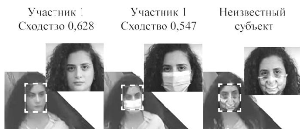
Рис. 3. Сценарий использования состязательных заплаток для обмана биометрических систем (неверная идентификация субъекта)
