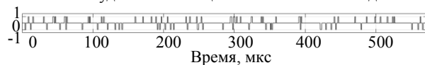
д – битовые ошибки, полученные в результате демодуляции принятой смеси (ОПС = 10 дБ) и сравнения с передаваемой битовой последовательностью
