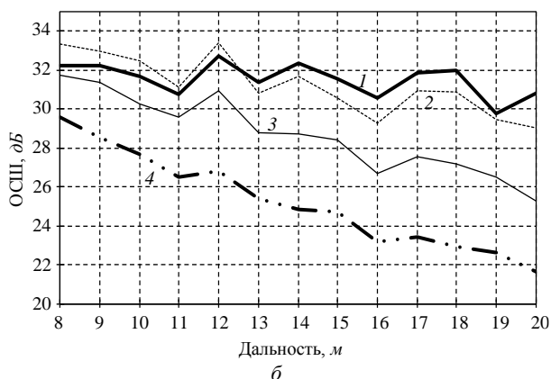
Рис. 6. Графики зависимости СКО и ОСШ от дальности: 1 – фильтр Гаусса (СКО равно 7); 2 – 3D-фильтр (сигма равна 25); 3 – медианный фильтр (1×7); 4 – без обработки
