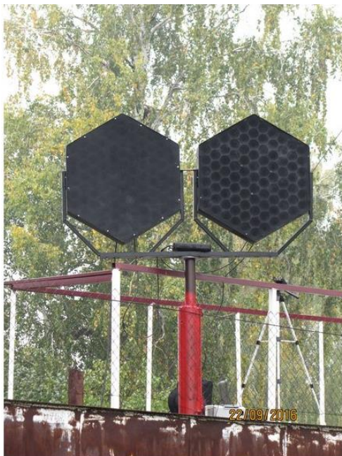
Рис. 4. Внешний вид линейного массива АИ91Мх2, установленного на экспериментальной площадке
