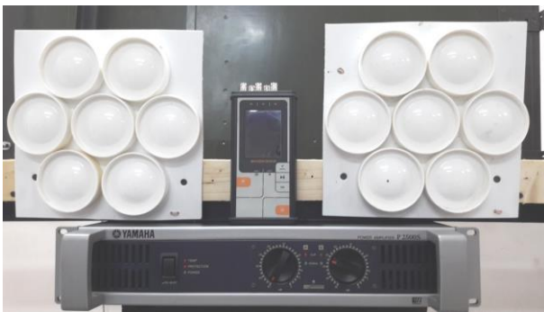
Рис. 3. Внешний вид экспериментального макета линейного массива АИ7х2. В центре показан шумомер 1-го класса точности, внизу – усилитель мощности
