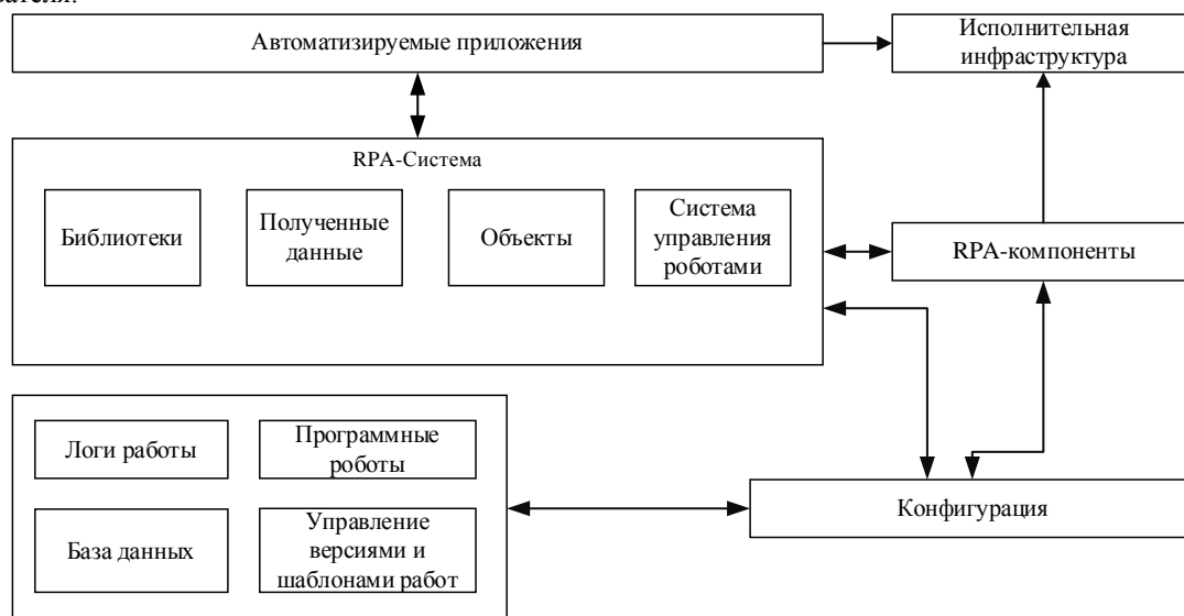
Рис. 1. Принцип автоматизации посредством RPA и его архитектура
