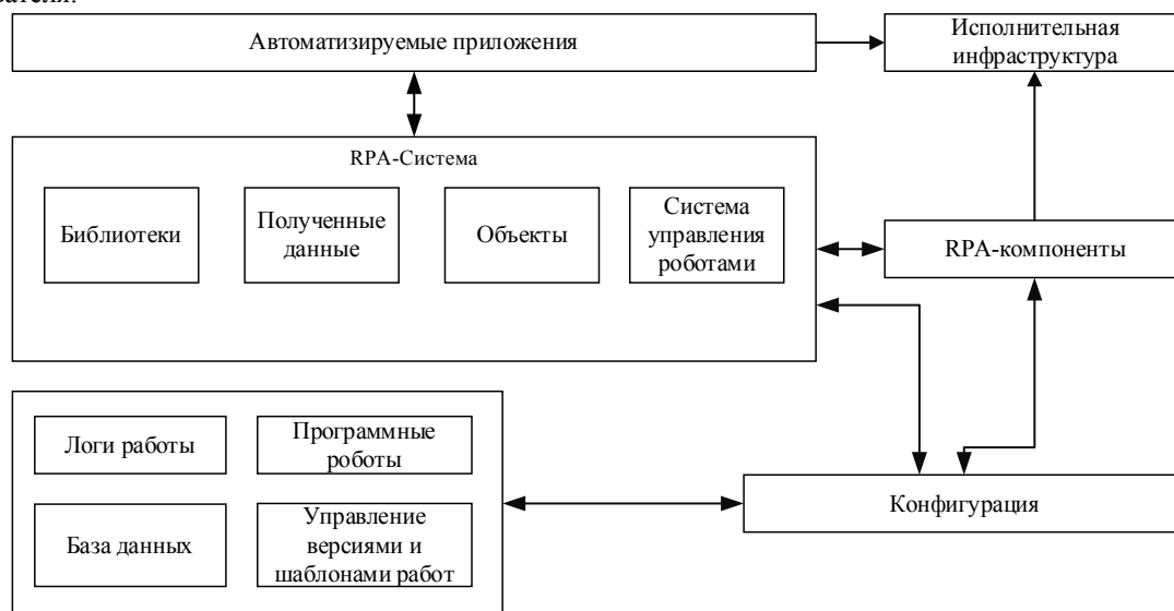
Рис. 1. Принцип автоматизации посредством RPA и его архитектура
