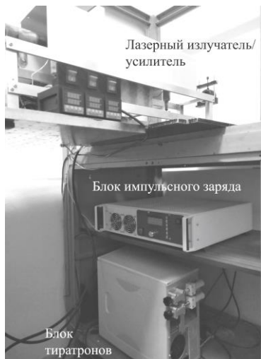
Рис. 3. Внешний вид лазерной системы с одной лазерной трубкой
