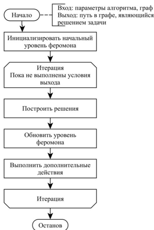
Рис. 1. Блок-схема алгоритма муравьиных колоний
