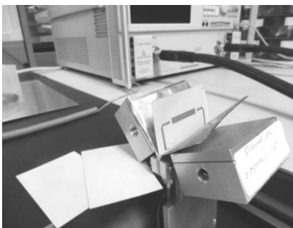
Рис. 3. Измерительная оснастка метода IPC TM-650 2.5.5.5
