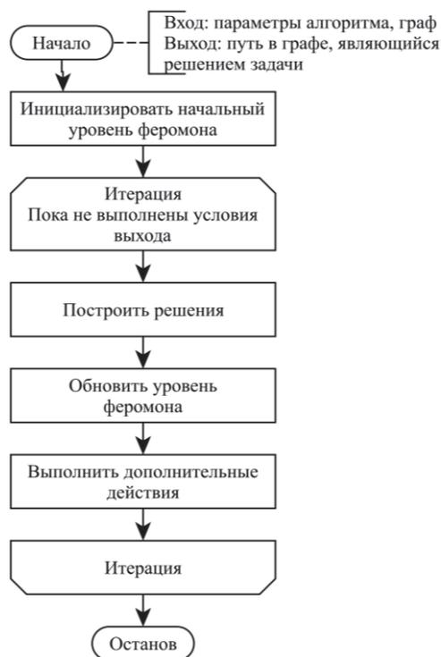
Рис. 1. Блок-схема алгоритма муравьиных колоний
