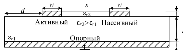
Рис. 2. Поперечное сечение структуры для способа трассировки печатных проводников с дополнительным диэлектриком для схем с МР [48]
