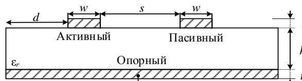
Рис. 1. Поперечное сечение структуры для способа трассировки печатных проводников схем с МР [47]
