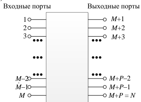
Рис. 2. Пример устройства для измерения матрицы рассеяния
