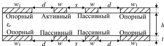
Рис. 15. Поперечное сечение структуры для способа трехкратного МР проводников печатной платы [62]
