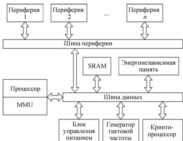
Рис. 1. Структурная схема типовой защищенной микросхемы
