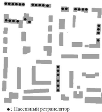
Рис. 4. Распределение ретрансляторов по крышам зданий
