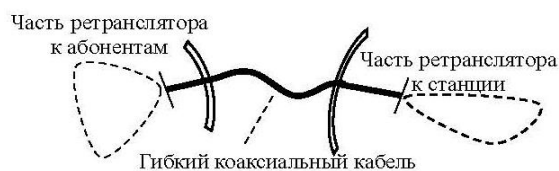
Рис. 1. Пассивный ретранслятор, состоящий из двух параболических антенн, соединённых гибким кабелем
