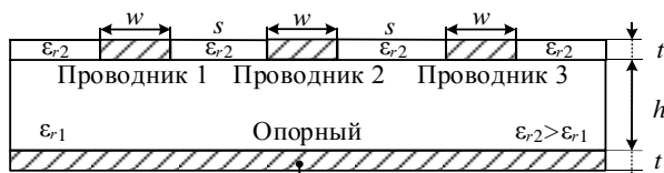
Рис. 6. Поперечное сечение структуры для способа трассировки печатных проводников с дополнительным диэлектриком для двукратного МР [52]
