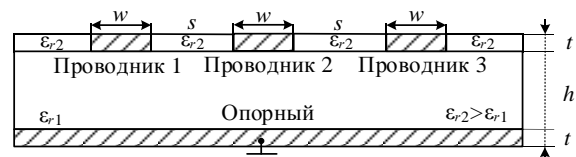
Рис. 18. Поперечное сечение структуры для способа переключения цепей с двукратным МР после отказов [73]
