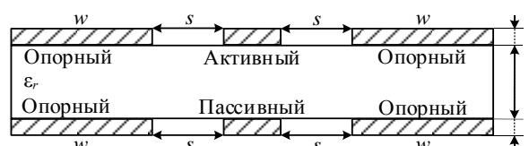
Рис. 3. Поперечное сечение структуры для способа трассировки двухсторонней ПП с МР [49]
