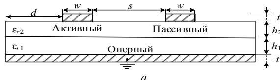
Рис. 6. Поперечное сечение структуры для способа трассировки печатных проводников с дополнительным диэлектриком для двукратного МР [52]
