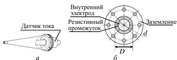
Рис. 10. Конусообразный адаптер для соединения имитатора ЭСР с датчиком тока (а); его поперечное сечение (б)
