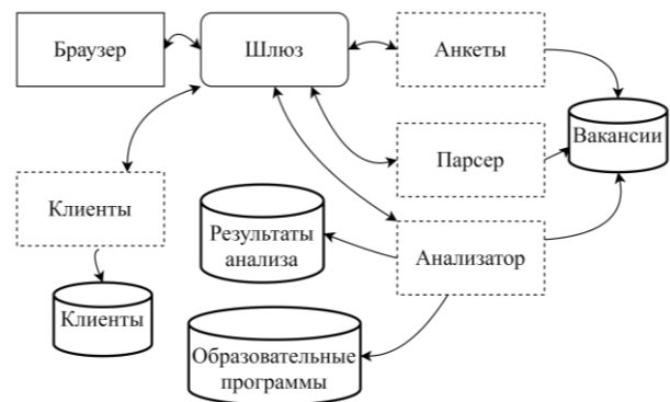
Рис. 1. Схема микросервисной архитектуры информационной системы
