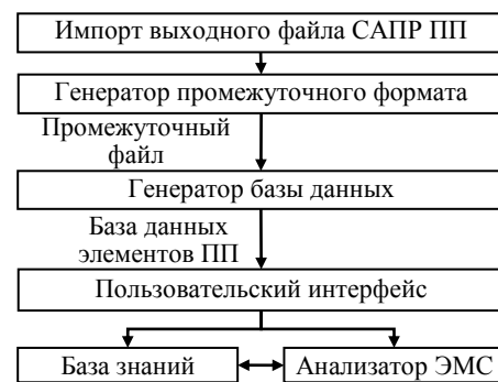
Рис. 3. Структурная схема ЭС EMC Expert [24]
