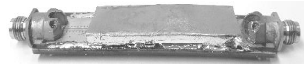
Рис. 7. Конструкция фильтра нижних частот с крышкой
