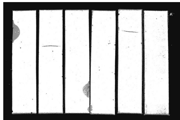
Рис. 5. Изображения кирпичей с различного рода дефектами
