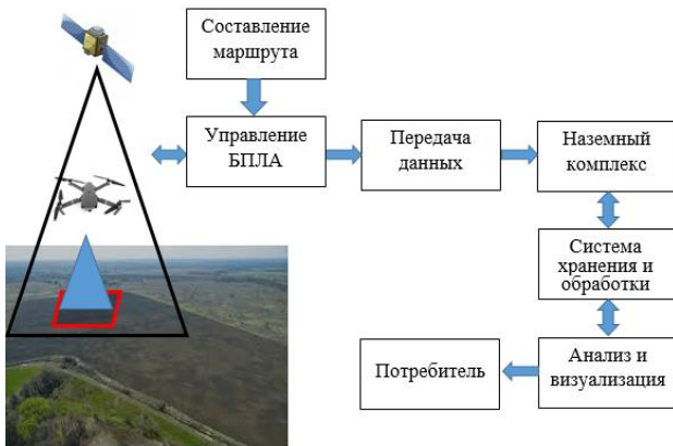
Рис. 1. Исследование поверхности земли методами совмещения изображений БПЛА и спутников
