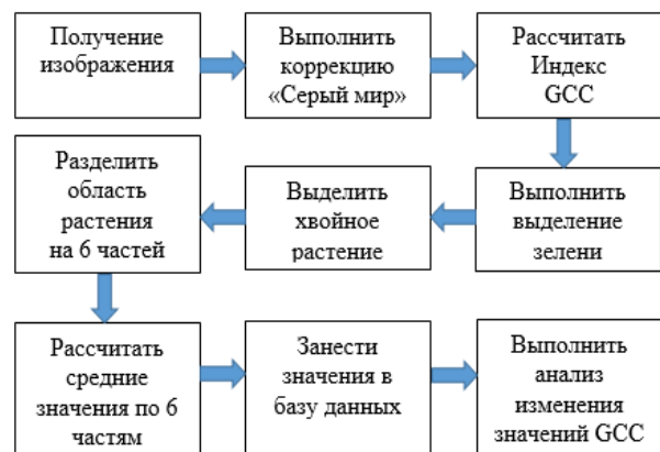
Рис. 1. Алгоритм получения и обработки изображения
