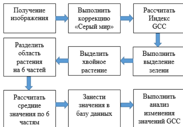
Рис. 1. Алгоритм получения и обработки изображения
