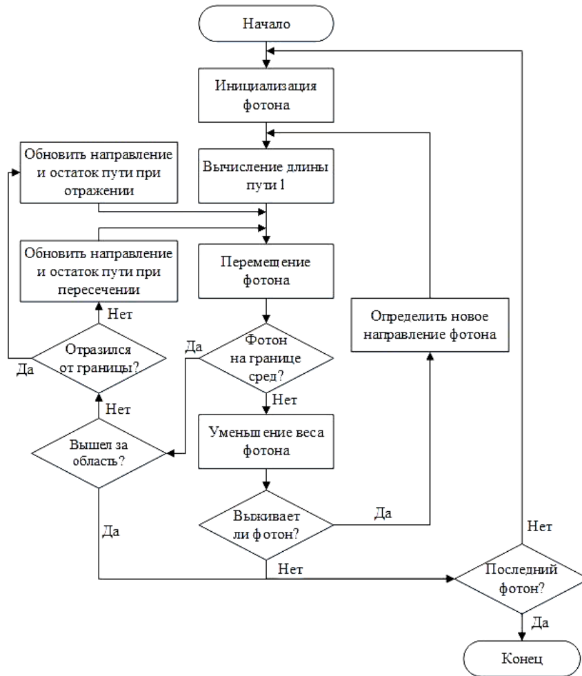
Рис. 2. Схема алгоритма моделирования методом Монте-Карло
