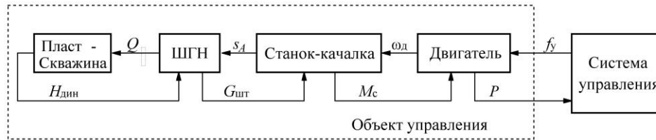
Рис. 1. Структурно-функциональная схема объекта управления: Q – подача ШГН; s_A – закон движения полированного штока; \omega_d – угловая скорость вращения вала двигателя; f_y – частота управляющего сигнала, задаваемая системой управления; M_c – момент сопротивления на валу электродвигателя; G_{шт} – усилия на полированном штоке; H_{дин} – динамический уровень жидкости в затрубном пространстве нефтяной скважины; P – величина средней за период качания балансира потребляемой приводом мощности
