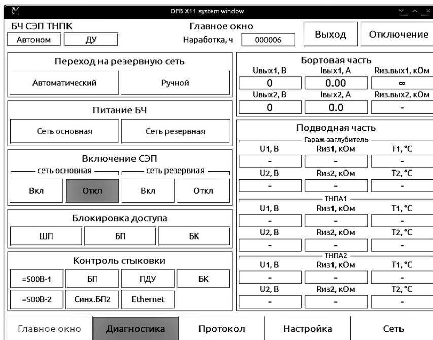
Рис. 4. Интерфейс главного окна управления СЭП ТНПА
