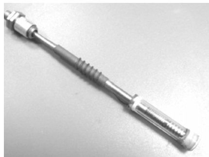
Рис. 2. СВЧ-резонатор с оконечным цилиндрическим конденсатором для неинвазивной диагностики меланомы
