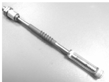
Рис. 2. СВЧ-резонатор с оконечным цилиндрическим конденсатором для неинвазивной диагностики меланомы
