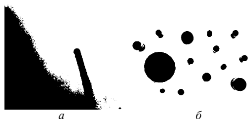
Рис. 3. Бинаризация изображения методом Гонсалеса-Вудса. Изображение с неравномерным освещением – a . Изображение с объектами различных размеров – б
