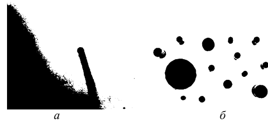
Рис. 2. Бинаризация изображения методом Отсу. Изображение с неравномерным освещением – a . Изображение с объектами различных размеров – b
