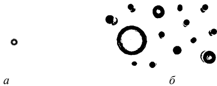
Рис. 8. Бинаризация изображения методом Сауволы. Изображение с неравномерным освещением – a . Изображение с объектами различных размеров – б
