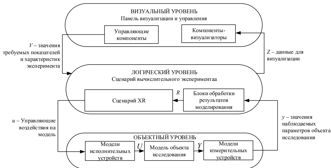
Рис. 1. Структура многоуровневой компьютерной модели для формирования и отладки графических сценариев
