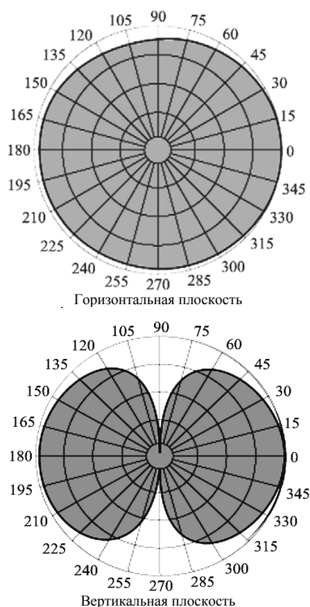
Рис. 6. Горизонтальная и вертикальная ДН штыревой антенны
