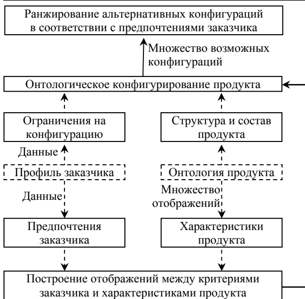
Рис. 1. Общая схема подхода к персонализированному конфигурированию продукта
