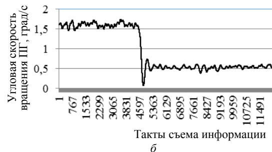
Рис. 8. Переходные процессы угловой скорости вращения ПГ: а – при работе ИЭП от двух датчиков обратной связи; б – при расположении датчика обратной связи только на оси ПГ
