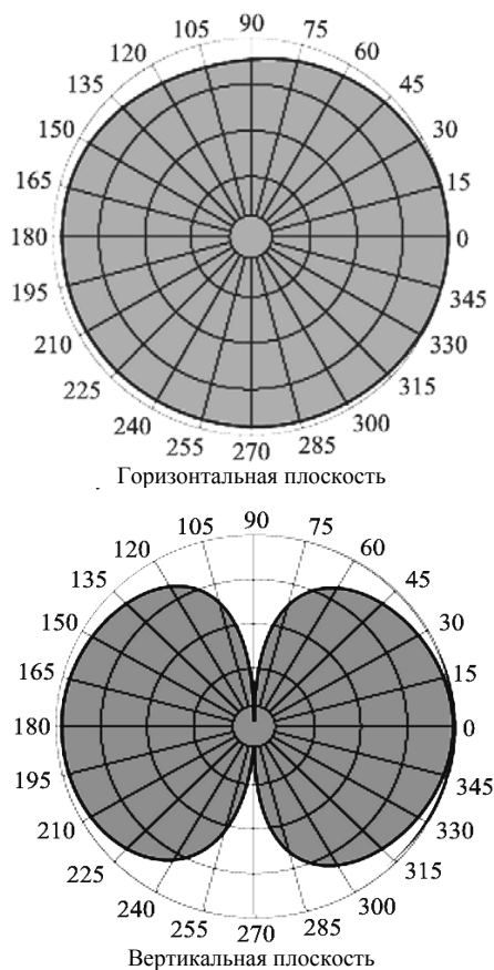
Рис. 6. Горизонтальная и вертикальная ДН штыревой антенны
